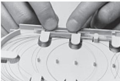
7.1.6 Для лотка на 8 соединителей два сварных сростка в защитных трубках устанавливаются друг над другом в одном держателе сростков.
