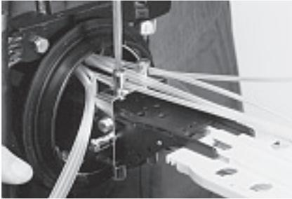
**5.5** Установите винт и шайбу в приспособление для фиксации силового элемента. Проденьте силовой элемент кабеля под шайбу и затяните винт. Отрежьте лишнюю длину силового элемента кабеля.
