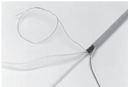
**5.2** Если требуется обеспечить непрерывность экрана, то необходимо заказать комплект FOSC-A-SHIELD-CON-KIT. Сделайте продольный надрез оболочки кабеля длиной 25 мм от кольцевого среза кабеля. Плоскогубцами прижмите к оболочке кабеля зажим экрана. Защитите зажим изолентой.
