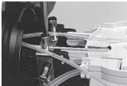
**11.5** Установите винт и шайбу в устройство фиксации силового элемента. Вставьте силовой элемент кабеля под шайбу и затяните винт. Отрежьте лишнюю часть силового элемента.
