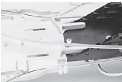
7.1.2 Осторожно отрежьте переходные трубки по отметке и прикрепите их к лотку двумя поясками. Переходная трубка не должна касаться волокон, уложенных в лотке.
