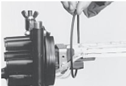
**10.3** Осторожно удалите уплотнительное кольцо. Защищайте уплотнительное кольцо и зону герметизации муфты от попадания грязи. (Если необходимо, то промойте их чистой водой).
