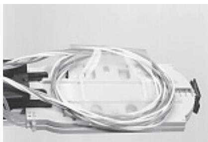
**15.2** Поместите неиспользуемые защитные трубки в рукав для хранения защитных трубок. Используйте пояски-стяжки для закрепления рукава.
