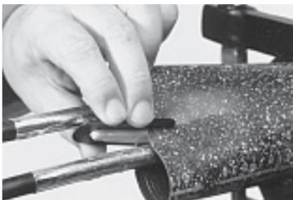
**6.5** Надвиньте овальную герметизирующую трубку на овальный ввод. Установите разветвительный зажим. Убедитесь, что термоусаживаемая трубка упирается в основание муфты, а разветвительный зажим вставлен на всю свою длину. Свяжите лентой два кабеля вместе.
