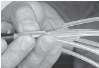
**5.3** На расстоянии 35 мм от среза оболочки кабеля надрежьте и удалите защитные трубки с волокон. Очистите от гидрофоба пучок волокон. Выберите переходную трубку, которая подходит по диаметру к защитной трубке. Наденьте переходную трубку на волокна и защитную трубку.
