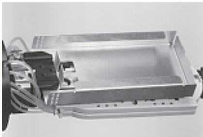
**16.1** Вставьте лоток FOSC-A-BASKET в держатель лотков и закрепите его винтами. Виток ленты волокон или пучка волокон (например, в кабеле с центральным размещением волокон в трубке) разместите в лотке и закрепите.
