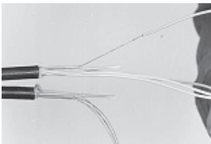
**5.1** Удалите оболочку кабеля (и экран, если он имеется) на отрезке длиной около 1,2 м в соответствии с правилами разделки. Если используются лотки для ленточного кабеля (4R4) или лотки высокой емкости (S16) оболочка удаляется на длине максимум 1,1 м. Удалите заполняющий компаунд (гидрофоб) с трубок с волокнами и отрежьте центральный силовой элемент на расстоянии 75 мм от среза внешней оболочки кабеля.
