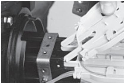
**8.1** При использовании дополнительного лотка совместите штифты лотка с отверстиями на держателе лотков основания муфты. Сожмите штифты лотка и вставьте лоток в держатель.
