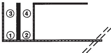
7.2.1 Лоток имеет 4 держателя для размещения защищенных сростков. В каждом держателе можно разместить максимум 4 сварных сростка, защищенных трубкой типа SMOUV-1120-2 (длина = 45 мм, внешний диаметр после усадки = 2,4 мм) или подобным протектором. **Убедитесь, что кабель разделан на максимальную длину, равную 1,1 м.**
