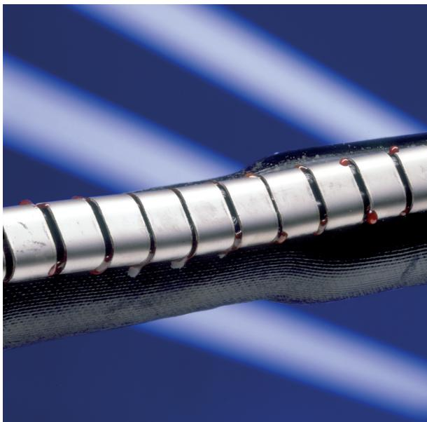
Комплект RDRK – это армированная стекловолокном манжета, разработанная для ремонта телефонных кабелей, находящихся под избыточным давлением, которая обеспечивает превосходную защиту от механических воздействий. В процессе монтажа необходимо перекрыть подачу воздушного давления в кабельную систему, которое может быть восстановлено только после завершения процесса монтажа.
